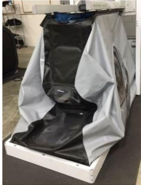
3. Localize as barras de retenção do saco na estrutura. As barras nas laterais e na parte traseira são mostradas. Você removerá essas três barras. Pode ser mais fácil começar com a barra traseira.
