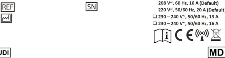
AlterG fabrica o sistema. Esta etiqueta está localizada no painel frontal próximo à base da esteira antigravidade e identifica o número de série e do modelo do sistema, bem como os requisitos de energia e tensão.
