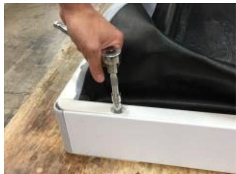
5. As barras laterais possuem uma ranhura na extremidade frontal e a ranhura cabe sob a barra adjacente. Afrouxe o fixador da barra adjacente e levante a barra lateral para fora.
