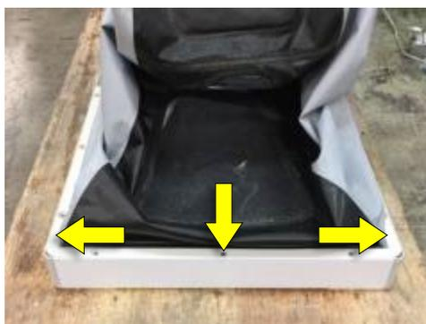
4. 使用带 10 毫米套筒的套筒扳手从紧固螺栓上拧下紧固件。
