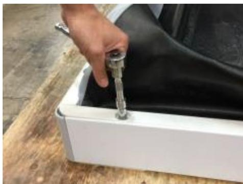
5. 侧面固定杆前端有一个插槽，插槽贴合在相邻固定杆的下方。拧松相邻固定杆上的紧固件，然后抬起侧面固定杆。
