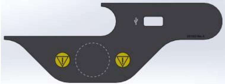
紧急停止标签位于触摸屏下方的控制舱上。它指示操作反重力跑台时安全磁铁应放置的位置。如果安全磁铁未放置在“EMERGENCY STOP”（紧急停止）字样下的圆柱上，反重力跑台将不会运行。使用过程中，如果出现任何紧急情况，用力拉磁铁连接的安全绳将使磁铁脱离，并停止跑步机。开始训练前，务必将安全绳固定在用户的手腕上。
