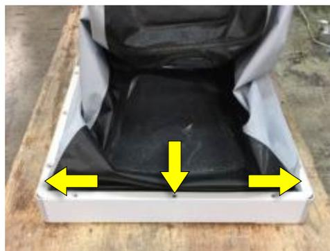
4. À l'aide d'une clé à douille avec une douille de 10 mm, dévissez les attaches des entretoises.
