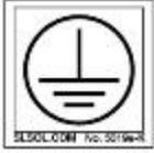
Cette étiquette est située à l'intérieur du panneau avant et indique une connexion à la terre. Utilisé pour la référence de potentiel zéro et la protection contre les chocs électriques.
