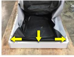
Utilizzando una chiave a tubo con una presa da 10 mm, svitare i dispositivi di fissaggio dai distanziatori.
