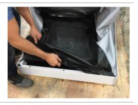
Riposizionare le barre fermasacco sul telaio. Le barre laterali devono essere posizionate per prime sotto la barra anteriore adiacente. Stringere la chiusura della barra anteriore.
