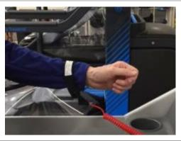
Posizionare il magnete di sicurezza del cordino direttamente sopra l'indicatore circolare sulla console etichettato "Arresto di emergenza"; in caso contrario, il tapis roulant antigravità non funzionerà.
