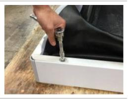
Le barre laterali hanno una fessura sull'estremità anteriore e la fessura si inserisce sotto la barra adiacente. Allentare il dispositivo di fissaggio sulla barra adiacente, quindi sollevare la barra laterale.
