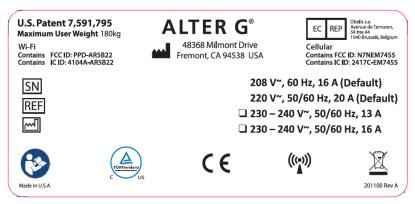
AlterG produce il sistema. Questa etichetta si trova sul pannello anteriore vicino alla base del tapis roulant antigravità e identifica il numero di serie e di modello del sistema, nonché i requisiti di alimentazione e tensione.
