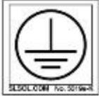
Dieses Etikett befindet sich auf der Innenseite der Frontplatte und zeigt an eine Verbindung zur Erde. Wird für Nullpotentialreferenz und Stromschlagschutz verwendet.
