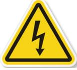
Dieses Etikett befindet sich innerhalb der Struktur des Anti-Schwerkraft-Laufbandes und zeigt an, dass an dieser Stelle eine Hochspannung anliegt. Wenn Sie dieses Etikett sehen, dürfen Sie keine der Komponenten, an denen es angebracht ist, in die Nähe bringen oder zerlegen. Da die Hochspannung schwere oder tödliche Verletzungen verursachen kann, sollte nur ein qualifizierter AlterG-Service-Techniker Reparaturen durchführen.
