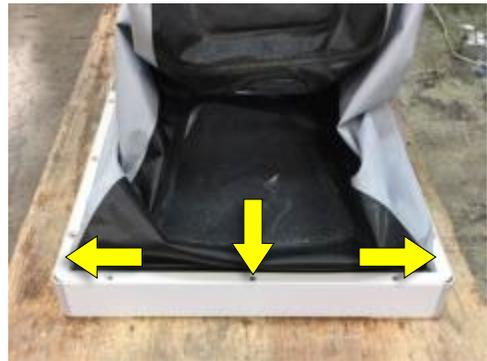
4. Lösen Sie die Befestigungselemente mit einem Steckschlüssel mit einem 10-mm-Steckschlüssel von den Abstandshaltern.
