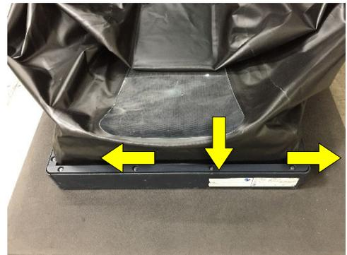
4. À l'aide d'une clé à douille munie d'une douille de 10 mm, dévissez les fixations des supports.
