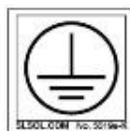
Cette étiquette est située à l'intérieur du panneau avant et indique une connexion à la terre. Elle est utilisée pour la référence au potentiel zéro et la protection contre les chocs électriques.
