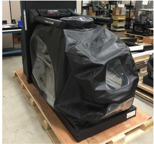
3. Repérez les barres de maintien du sac sur le cadre. Les barres situées sur les côtés et à l'arrière sont représentées. Vous allez retirer ces trois barres. Il peut être plus facile de commencer par la barre arrière.
