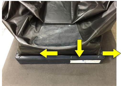
4. Торцовым ключом с насадкой на 10 мм открутите крепления стоек.
