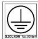
Esta etiqueta está ubicada en el interior del panel frontal e indica una conexión a tierra. Se utiliza para referencia de potencial cero y protección contra descargas eléctricas.
