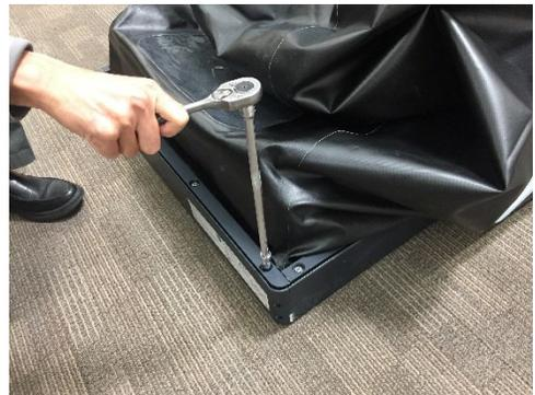
5. Saque las barras completamente del marco y déjelas a un lado con los sujetadores.
