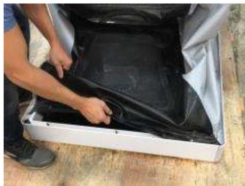
2. Substitua as barras de retenção do saco na estrutura. As barras laterais devem ser colocadas primeiro sob a barra frontal adjacente. Aperte o fixador da barra frontal.
