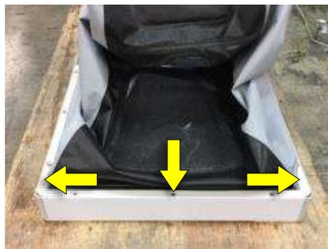
4. Usando uma chave de caixa com um soquete de 10 mm, desparafuse os prendedores dos espaçadores.
