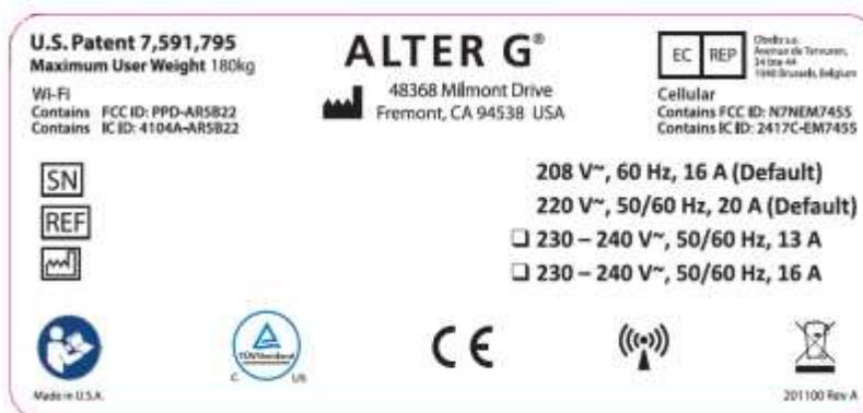
AlterG fabrica o sistema. Esta etiqueta está localizada no painel frontal próximo à base da esteira anti-gravidade e identifica o número de série e do modelo do sistema, bem como os requisitos de alimentação e tensão.
