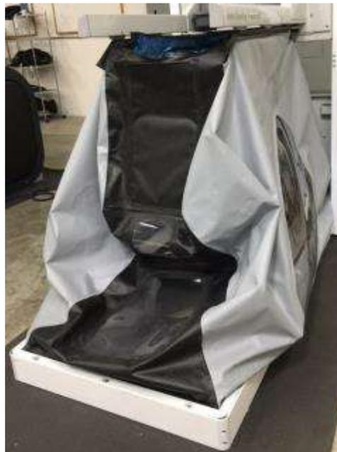
3. Localize as barras de retenção do saco na estrutura. As barras nas laterais e na parte traseira são mostradas. Você removerá essas três barras. Pode ser mais fácil começar com a barra traseira.
