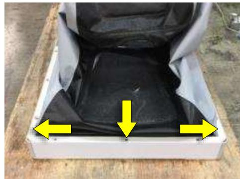
4. Pomoću ključa s nasadnim ključem od 10 mm odvijte pričvršćivače sa stajačih mesta.
