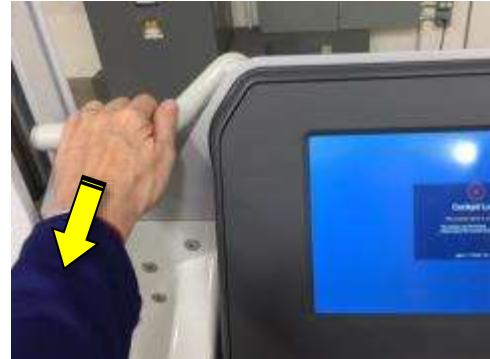
2. Uhvatite se za rukohvate i pomaknite kokpit gore ili dolje kako biste ga postavili na visinu koja postavlja patentni zatvarač na ilijačni vrh (gornji, vanjski rub zdjelične kosti osjeća se odmah ispod razine struka). Za dodatnu potporu prtljažnika, kokpit se može postaviti više.
